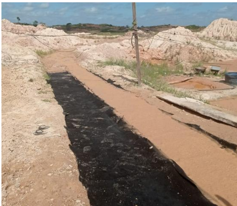
Figura 4: Depósito de rejeito e tanque de extração de ouro com uso de cianeto.
