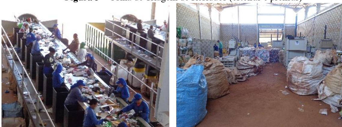
Figura 3 – Usina de Triagem de Resíduos (esteiras e prensas)
