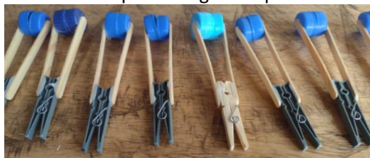
Figura 3 - Pegadores adaptados com pregador, palito de sorvete e tampinha de garrafa pet
