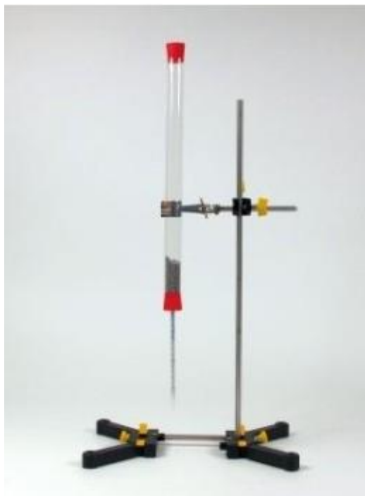
Figura 2. Experimento de transformação de Energia Mecânica em Energia Térmica.
