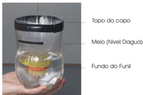
Figura 1 – Armadilha produzida com garrafa PET para captura de A. aegypti
